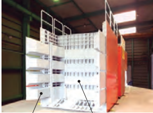
スライド式土留 隔壁
