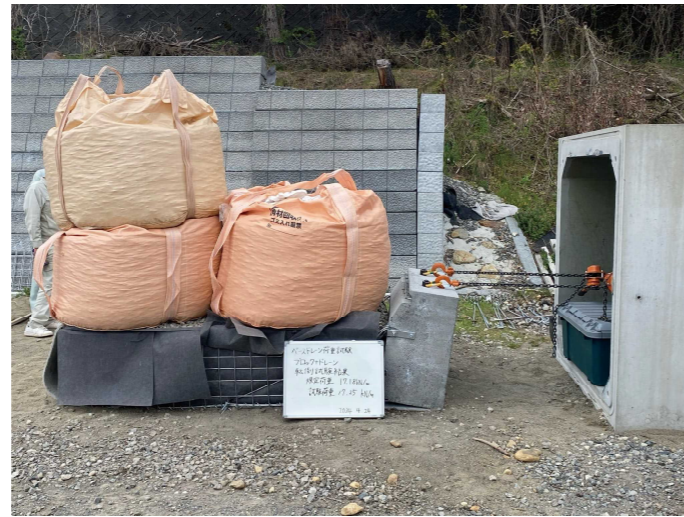
転倒試験によって、ベースドレーンが法面ブロックを支持できることを確認
