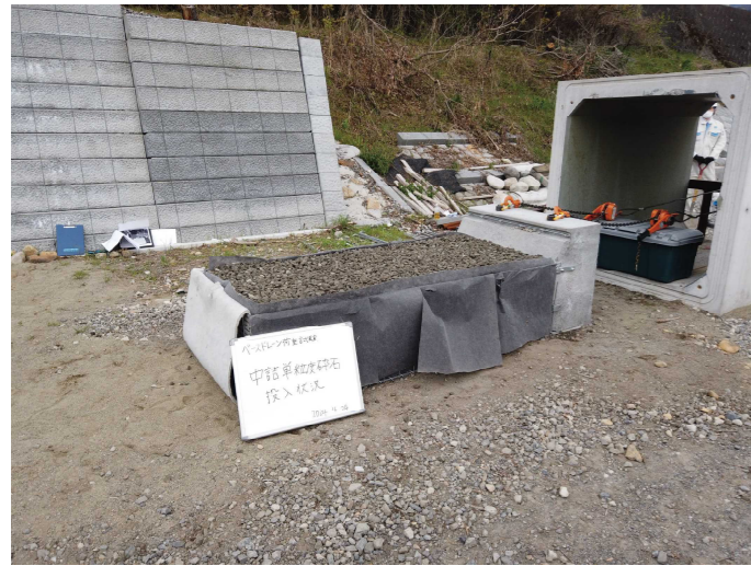
転倒試験によって、ベースドレーンが法面ブロックを支持できることを確認
