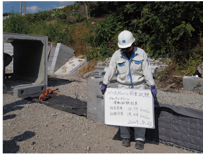
滑動試験によって、基礎ブロックとドレーンエの連結一体性を確認
